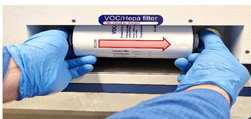
Obrázek 12.2 Postup vkládání a vyjímání filtru VOC/HEPA
