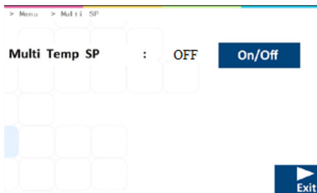
Obrázek 13.27 Zobrazení nastavené hodnoty pro více teplot na vícekomorových IVF inkubátorech MIRI® TL6 a MIRI® TL12
