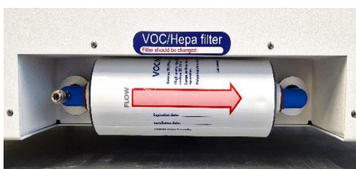
Obrázek 12.3 Správně nainstalovaný filtr VOC/HEPA
